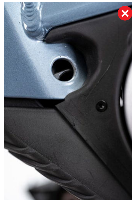
OBRÁZOK 6: OVERENIE SÚSTREDNOSTI DIERY V RÁME A BATÉRIÍ
