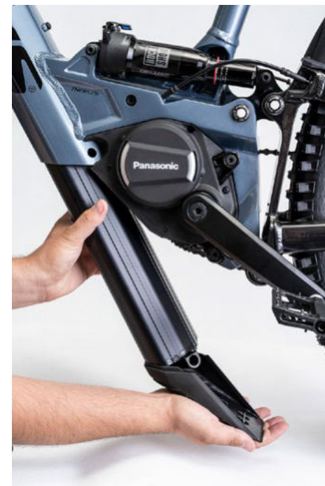
OBRÁZOK 3: SPRÁVNE DRŽANIE BATÉRIE POČAS VYŤAHOVANIA
