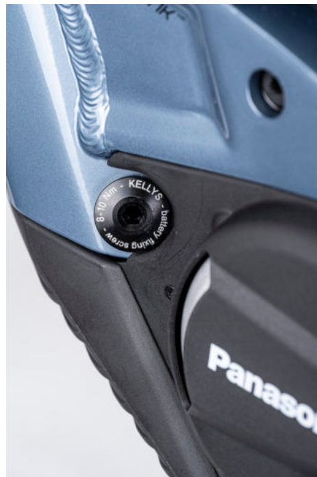
OBRÁZOK 10: HLAVA SKRUTKY S PREDPÍSANÝM MOMENTOM
