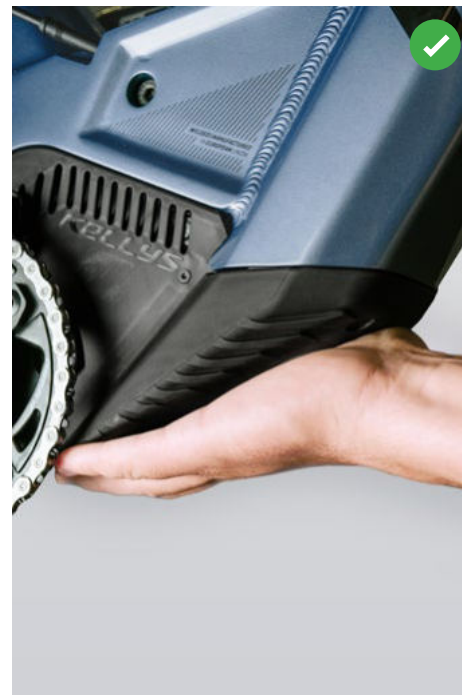
OBRÁZOK 8: OVERENIE PREKRYTIA KRYTU MOTORA KRYTOM BATÉRIE NA PRAVEJ STRANE (STRANA POHONU)
