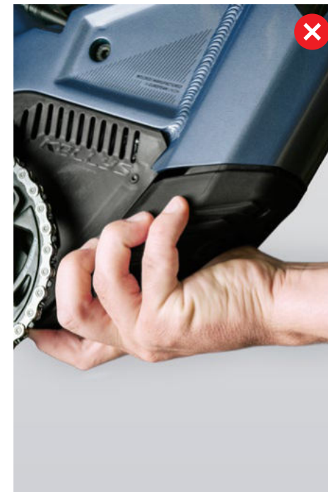
OBRÁZOK 8: OVERENIE PREKRYTIA KRYTU MOTORA KRYTOM BATÉRIE NA PRAVEJ STRANE (STRANA POHONU)
