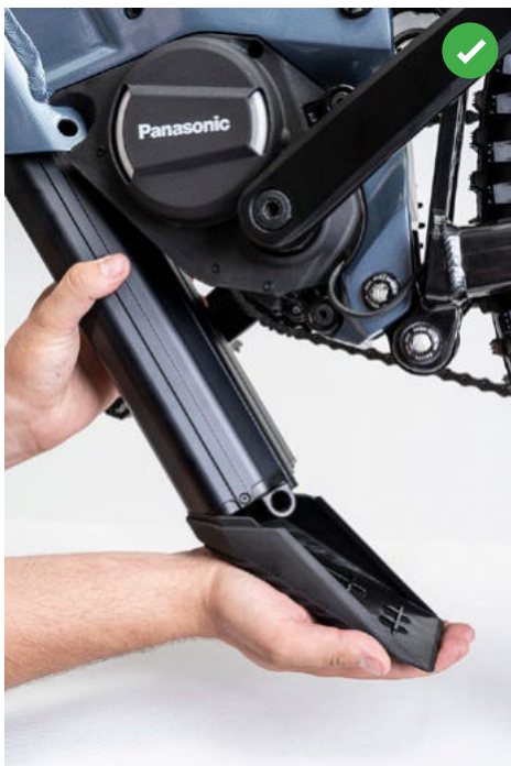
OBRÁZOK 4: SPRÁVNE DRŽANIE BATÉRIE
