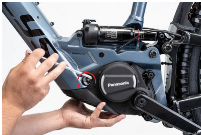
OBRÁZOK 1: UMIESTNENIE SKRUTKY A SMER OTÁČANIA
