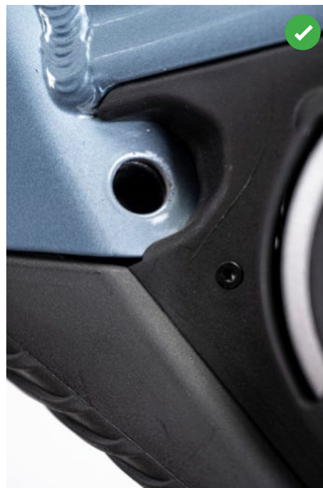
OBRÁZOK 6: OVERENIE SÚSTREDNOSTI DIERY V RÁME A BATÉRIÍ
